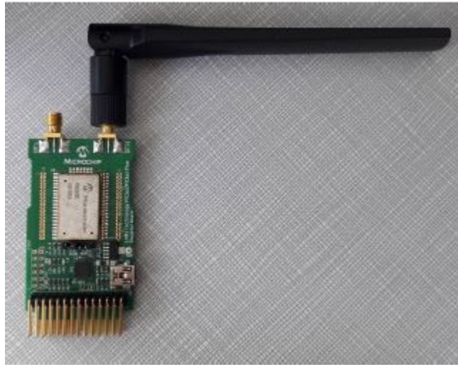
Récepteur LoRa, utilisé au sol avec un ordinateur
