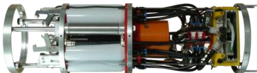
**Fig. 3 : Modèle de vol du SSIE (système de séparation inter-étages).**
