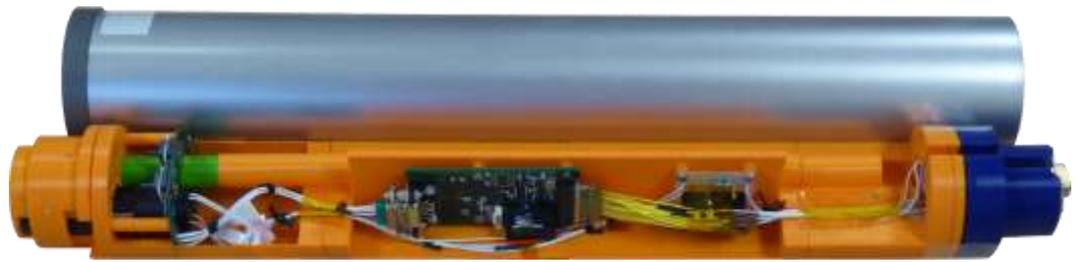
**Fig. 2 : Modèle de vol du Faux Propulseur Instrumenté.**
