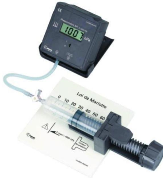
La première étape consiste à connaître la relation entre le volume d'air dans la seringue et la pression (on utilise alors un pressiomètre étalonné).
