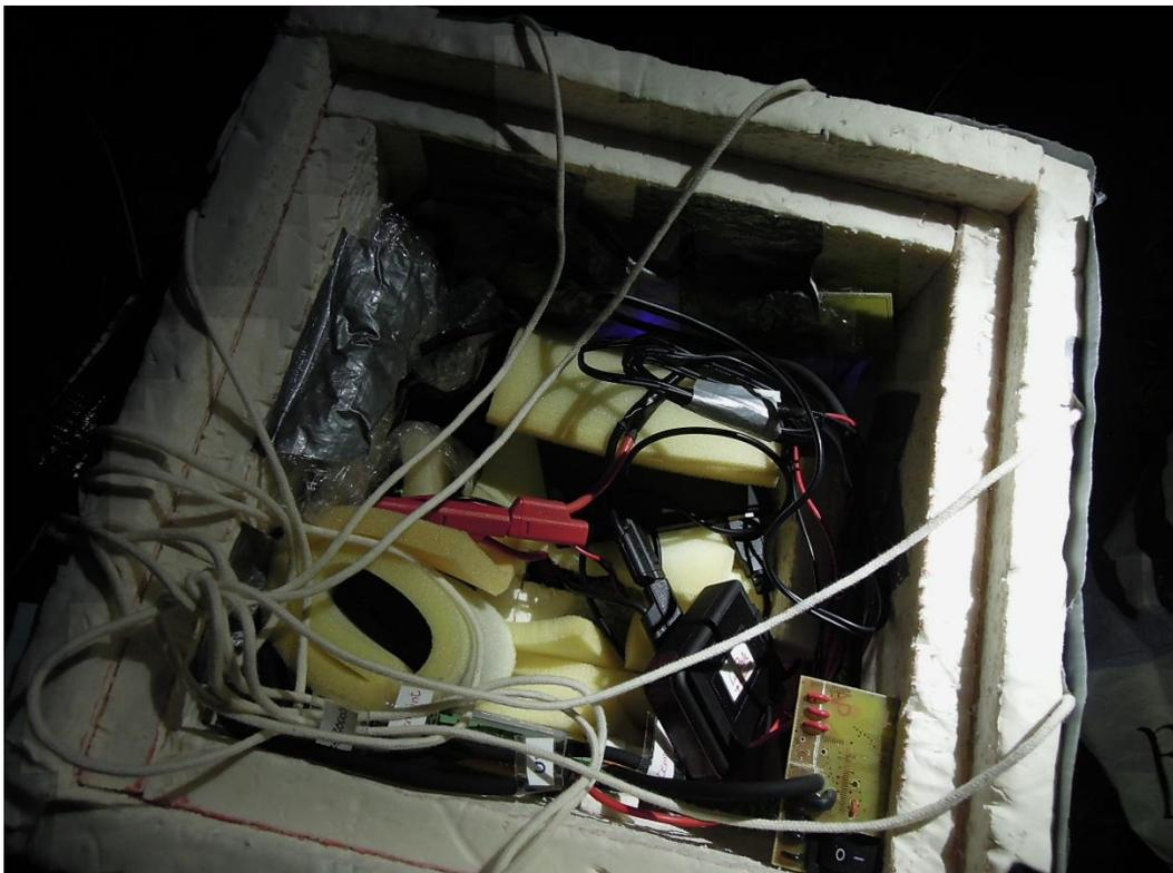
**19h : on ouvre la nacelle au cutter.** Tous les circuits sont encore sous tension. Des leds bleues témoignent de l'activité d'une carte Arduino... On mesure la tension batterie : 7,2V !
