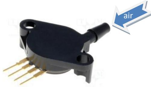
Le principe est basé sur l'effet piézoélectrique : l'air entrant par l'orifice P1 va exercer une force (donc une pression) sur la surface sensible du capteur. Cette force va créer une tension aux bornes de cet élément sensible, proportionnel à la force, donc proportionnel à la pression.
