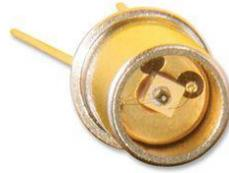
Cette photodiode est sensible aux UV A, B et C comme le montre sa courbe de sensibilité spectrale :
