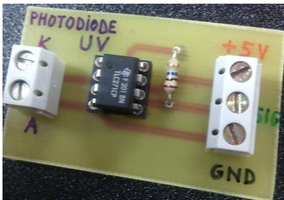
Les essais de l'an dernier nous avaient permis de tracer une courbe d'étalonnage sommaire. Plusieurs mesures ont été effectuées en extérieur pendant des journées ensoleillées avec un indice UV donné par Météo France entre 1 et 3. La photodiode était maintenue face au soleil pour obtenir une puissance d'irradiation maximale et une tension lue au voltmètre maximale.
