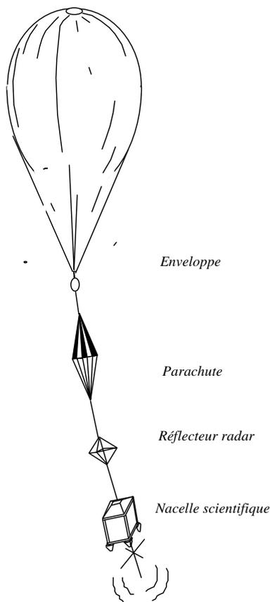
**L'enveloppe** : fabriquée avec un matériau très élastique (latex ou chloroprène) de quelques microns d'épaisseur. Elle est donc assez fragile et les opérations de gonflage doivent être effectuées avec précaution. Elle est gonflée à l'hélium, gaz inerte moins dense que l'air, ininflammable et donc parfaitement sans danger, à la différence de l'hydrogène dont l'utilisation est interdite pour cette application.
