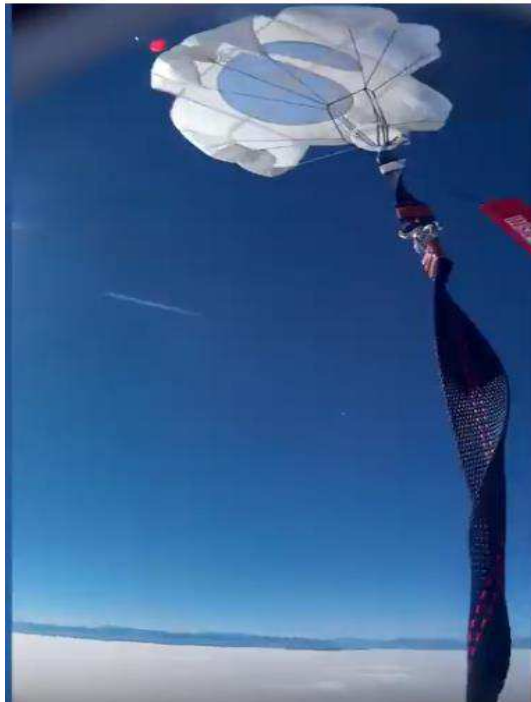
Figure 9: Attache parachute de type sangle, vol fusée FSX32 du CLES FACIL
