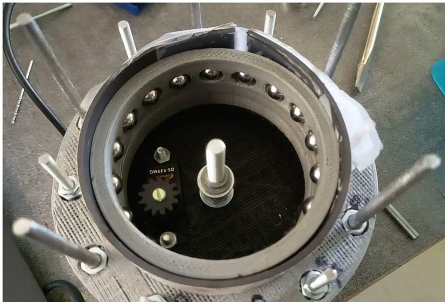
Figure 2: Système de séparation - assemblage acier / PLA
