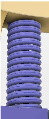
Les ressort guidés par leur douilles sont compressés contre la structure du second étage et assurent une tension entre les étages.
