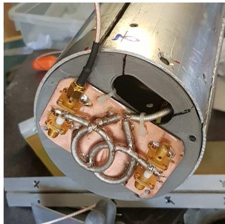
Figure 1 : connecteurs inadaptés au format tubulaire.
