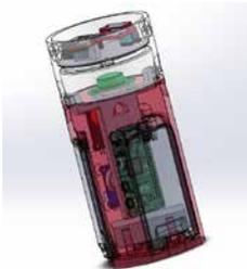
Figura 2. Disposición de los componentes electrónicos.
