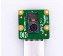
Figure 11. Módulo cámara V2 de Raspberry Pi
