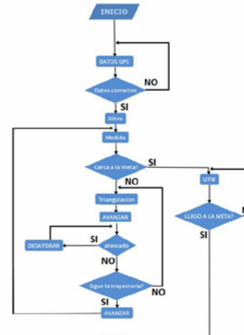
Figure 12. Diagrama de flujo del sistema de control de navegación autónoma.
