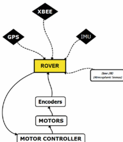
Figure 9. Diagrama del sistema electrónico, de transferencia de datos y de posicionamiento.
