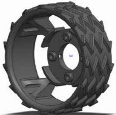
Figure 3. Ruedas con cocada y sin expansores.
