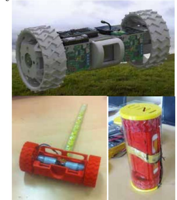
Figure 13. Diseño y ensamblaje del prototipo final.
