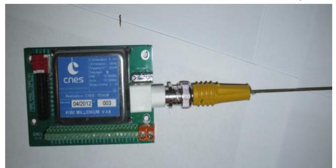
tension / paramètre physique mesuré. L'émetteur Kiwi Millenium permet d'envoyer 8 mesures simultanément toutes les 2 secondes. La distance de transmission est supérieure à 200 km<sup>4</sup>.
