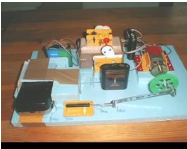
Système de déclenchement motorisé automatique d'un appareil photo
