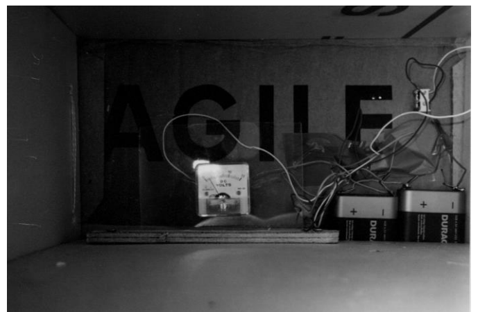
Photographie en vol d'un voltmètre relié à une thermistance placée à l'extérieur
