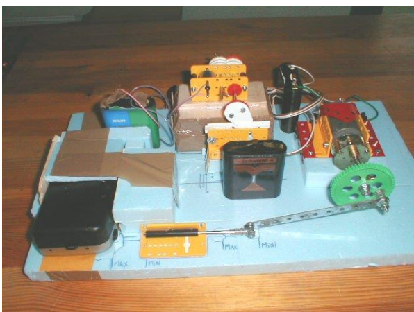
Système de déclenchement automatique d'un appareil photo
