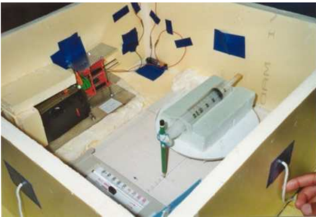
Mesure de pression par seringue
