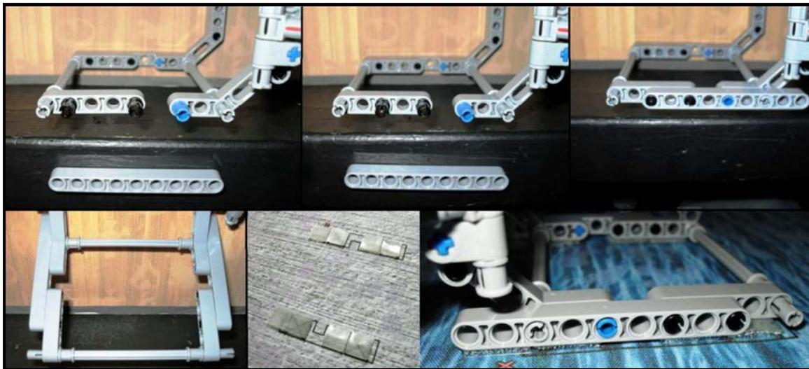
Le déplacement de la poutre ne change pas l'emplacement du modèle. Alignez l'arrière du pied sur sa marque et appuyez pour le fixer. Avant de fixer ces modèles, remarquez que deux des distributeurs sont construits en miroir des deux autres, donc assurez-vous que l'axe d'action sur le distributeur soit au-dessus d'une croix rouge du tapis.
