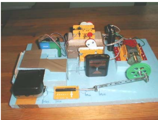
Système de déclenchement automatique d'un appareil photo
