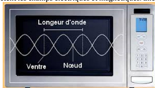
Représentation d'une onde électromagnétique.
