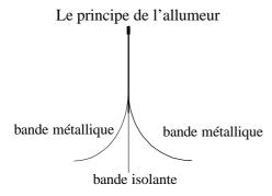
On reconnaît alors le principe classique des deux fils qui sont remplacés ici par deux bandes métalliques séparées par un papier isolant. On a donc bien le courant qui rentre par une patte et ressort par l'autre. La question suivante est naturellement : comment je les utilise ?
