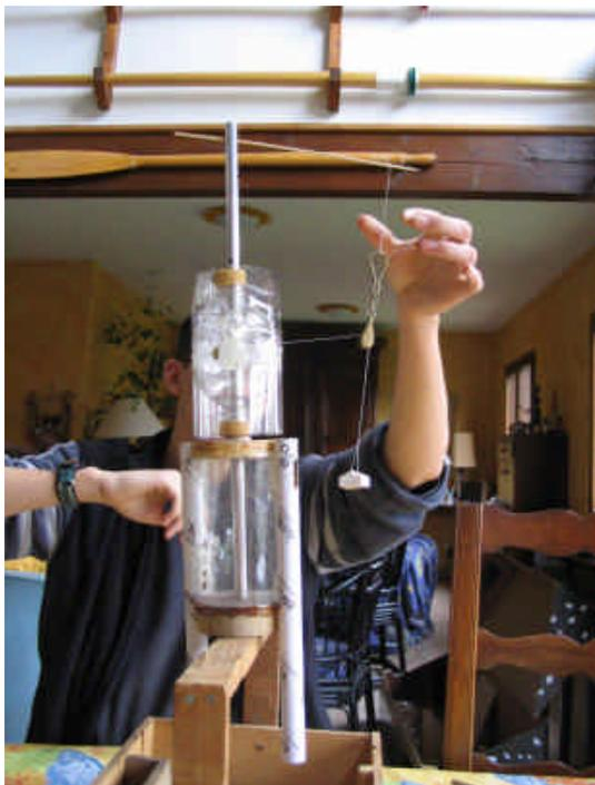
1) Détermination, par la masse, de la force nécessaire pour faire tourner la fusée
