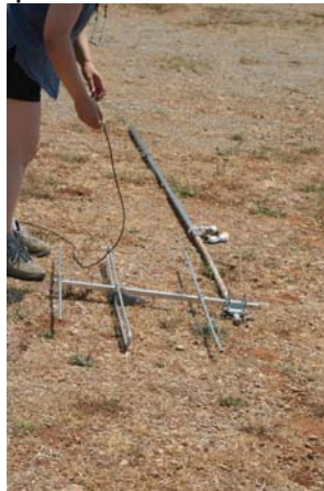
Figure 26 : Fabrication et montage de l'antenne
