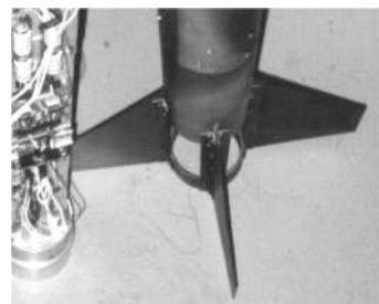
fig.2 version définitive des ailerons.
