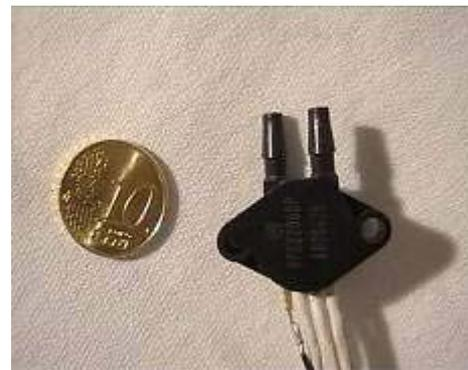
Les deux tensions délivrées par les capteurs sont filtrées (par un passe bas dont la fréquence de coupure est la moitié de la fréquence d'échantillonnage, pour satisfaire le théorème de Shannon), puis envoyées au PIC 16F877, qui effectue les conversions analogiques numériques, et génère les trames pour l'émetteur.
