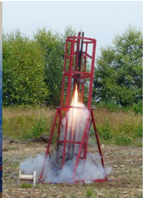
Sortie de Rampe (~20m/s)
