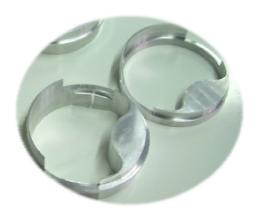
Le vissage et le dévissage de la vis provoque une translation verticale de celle-ci. Cependant, le moteur électrique est fixé à la structure de la fusée et ne peut donc pas subir de translation. Pour palier à ce problème, nous avons utilisé un accouplement entre l'arbre de sortie du moteur et la vis permettant d'absorber cette translation de par sa forme hélicoïdale.
