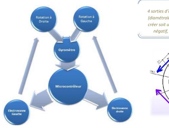
4 sorties d'air fonctionnant deux par deux (diamétralement opposées) de manière à créer soit un couple positif, soit un couple négatif, selon le sens de la rotation.
