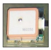
Ce récepteur possède par ailleurs une très grande sensibilité, et il recevait une moyenne de 10 satellites même dans la rampe (antenne dirigé vers le sol). Il va sans dire que la réception des satellites a été très bonne durant toutes les phases du vol, avec un nombre de satellites *en track* oscillant entre 8 et 11.
