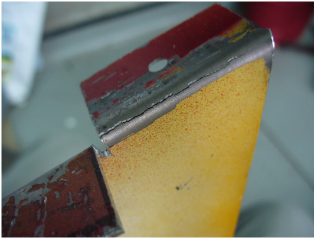
Figure 5: Fissure due au pliage de tôle d'aileron. Alliage de l'aluminium inconnu.
