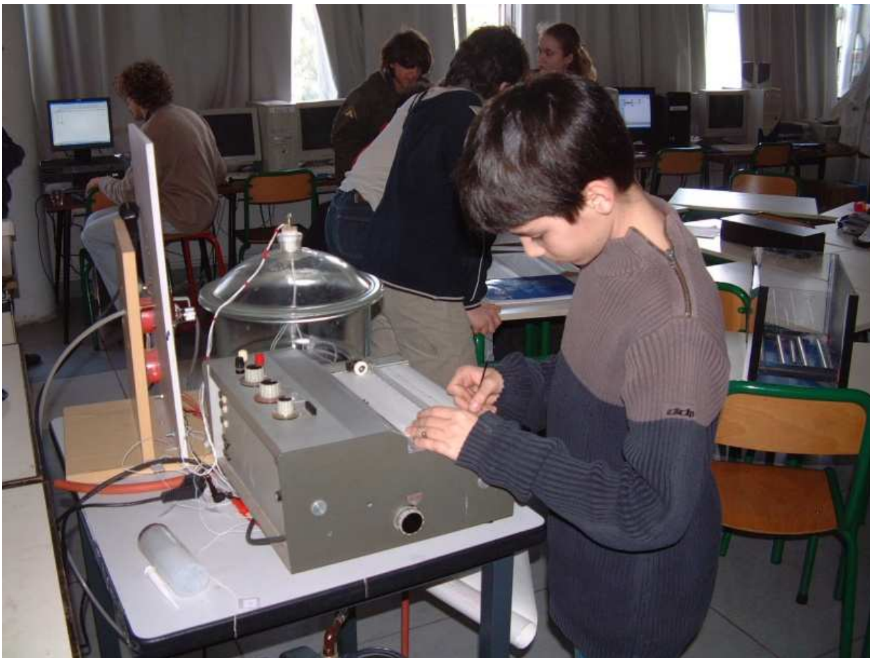
Sylvain chargé d'étalonner le capteur de pression.
