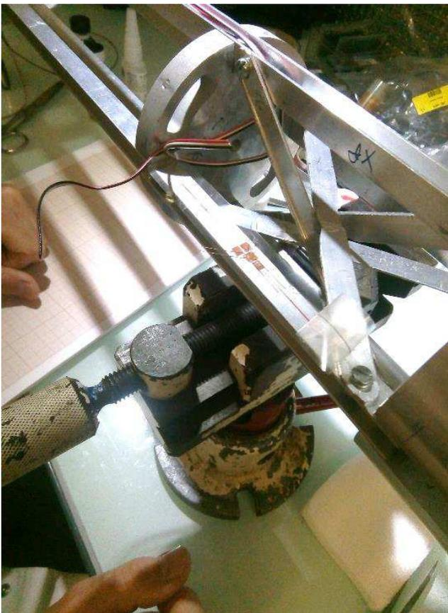
*Figure 1: Pose des jauges de déformations*
