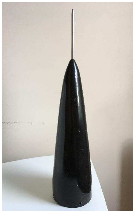
9 : ogive avec le tube de Pitot
