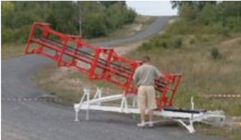
Figure 49 : Rampe CNES pour Fusex
