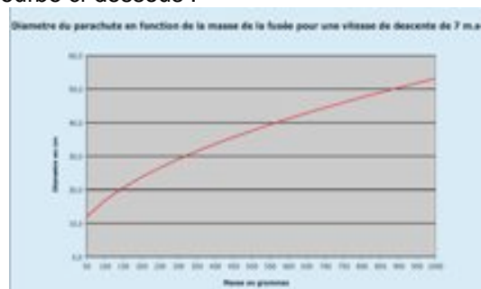
Figure 79 : Diamètre du parachute en fonction de la masse et d'une vitesse de descente de 7 m.s^{-1}
