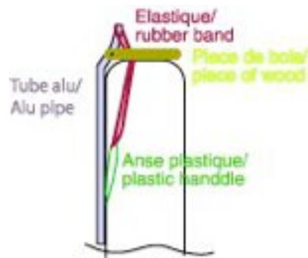
Figure 75 : Schéma explicatif de la photo ci-dessous, qui montre le système de déploiement des ailes
