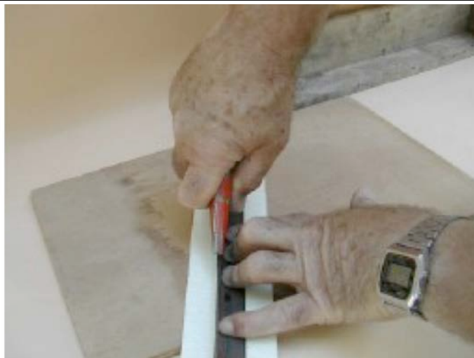
Figure 29 : Utilisation d'une cornière pour la découpe au cutter
