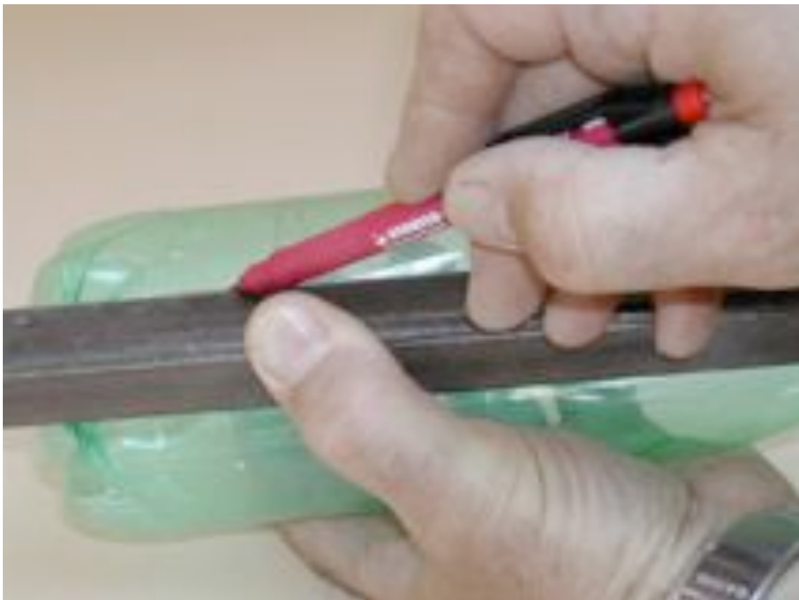
Figure 22 : Traçage à l'aide d'une cornière
