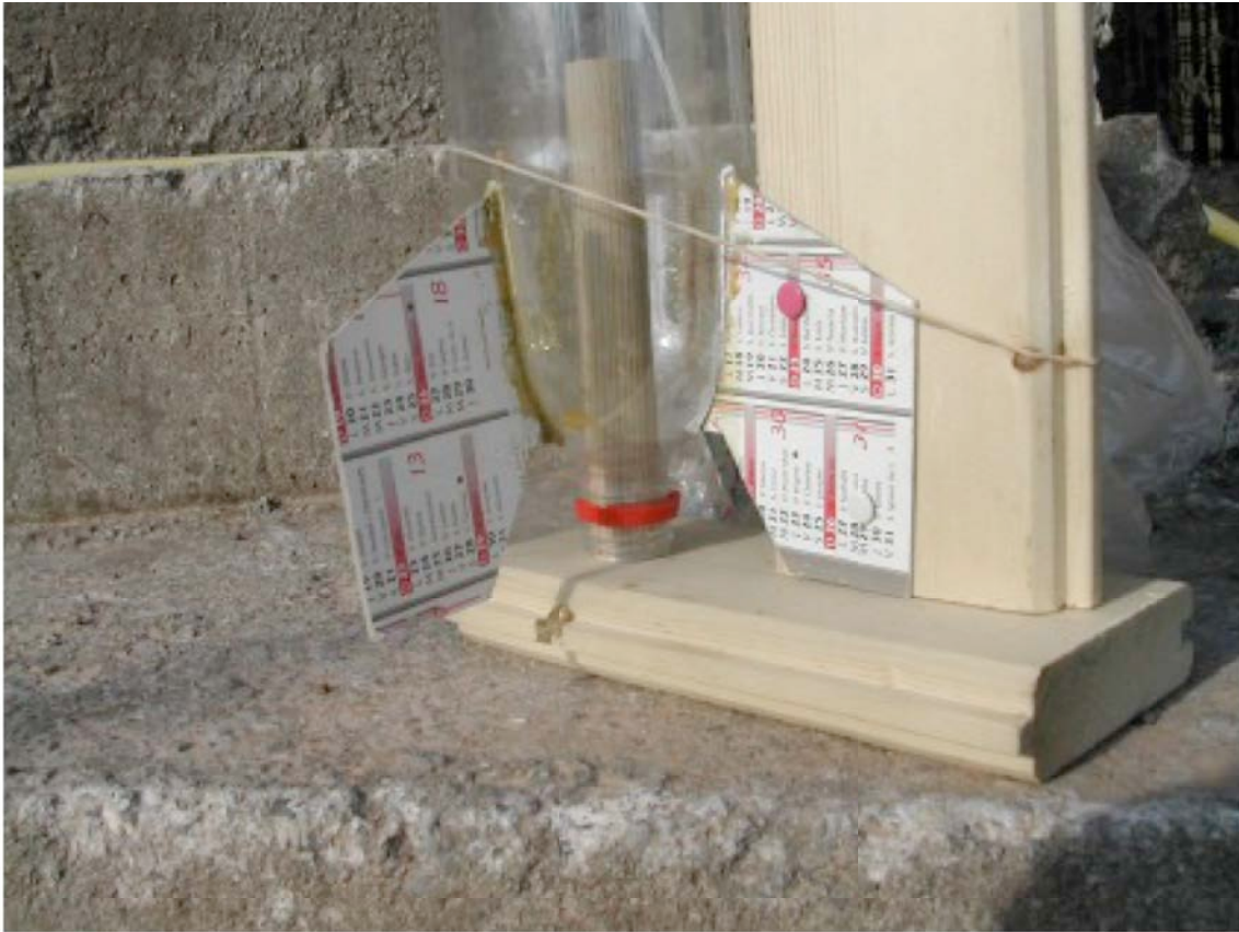
Figure 37 : Une méthode de collage d'ailerons
