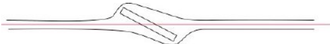
Figure 13 : écoulement de l'air autour d'un plan faisant un angle par rapport au flux
