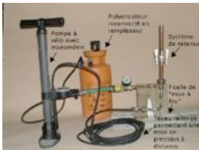
Figure 48 : Base de lancement complète avec lanceur, pompe à vélo, remplisseur d'eau
