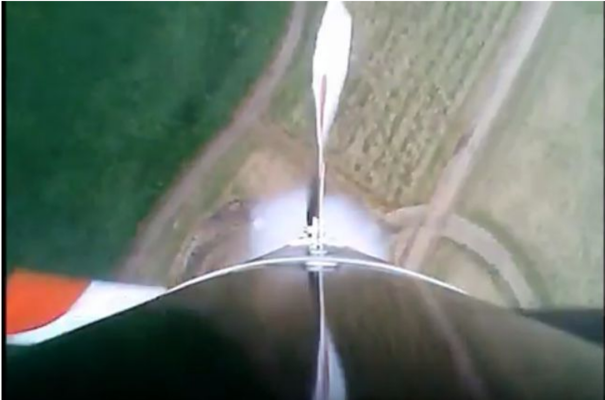
Figure 19 : Flottement des ailerons de la fusée du Team Kanzai Rocket Club lors du C'Space 2015
