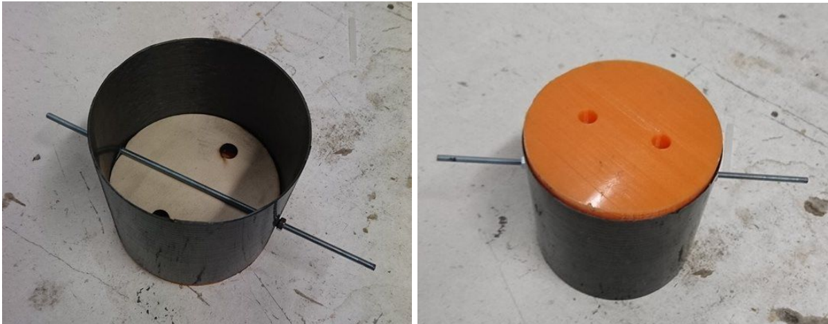
Figure 14 : dispositif de test du tube (vue de dessus et de dessous, l'effort est appliqué selon l'axe du tube sur la pièce orange)
