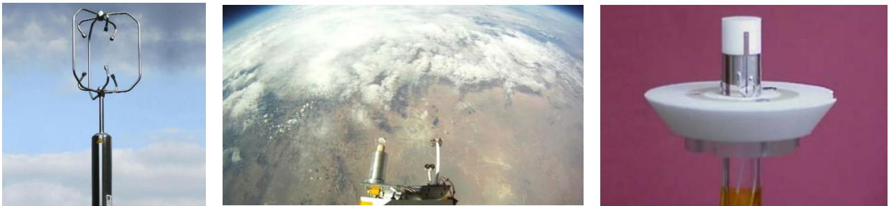
Anémomètre ultrasonique commercial, expérience financée par la NASA, anémomètre thermique conçu pour Beagle-2
