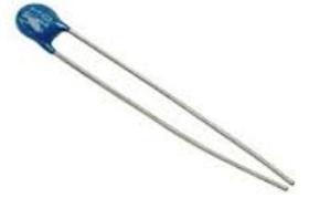
Le CTN va envoyer différentes mesures de tension (V) qui correspondront chacune à une température (°C) qu'on identifiera dans un tableau qui nous permettra de convertir les mesures obtenues par la CTN (5koms)
