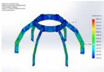
Figura 24. Análisis de caída de la capsula, Deformaciones Equivalentes
